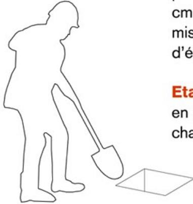
**Etape 1** – Réaliser la fondation du poteau - Creuser 1 trou de 50x50x45 cm ; couler un béton de réglage pour mise à niveau de 10 à 15 cm d'épaisseur
